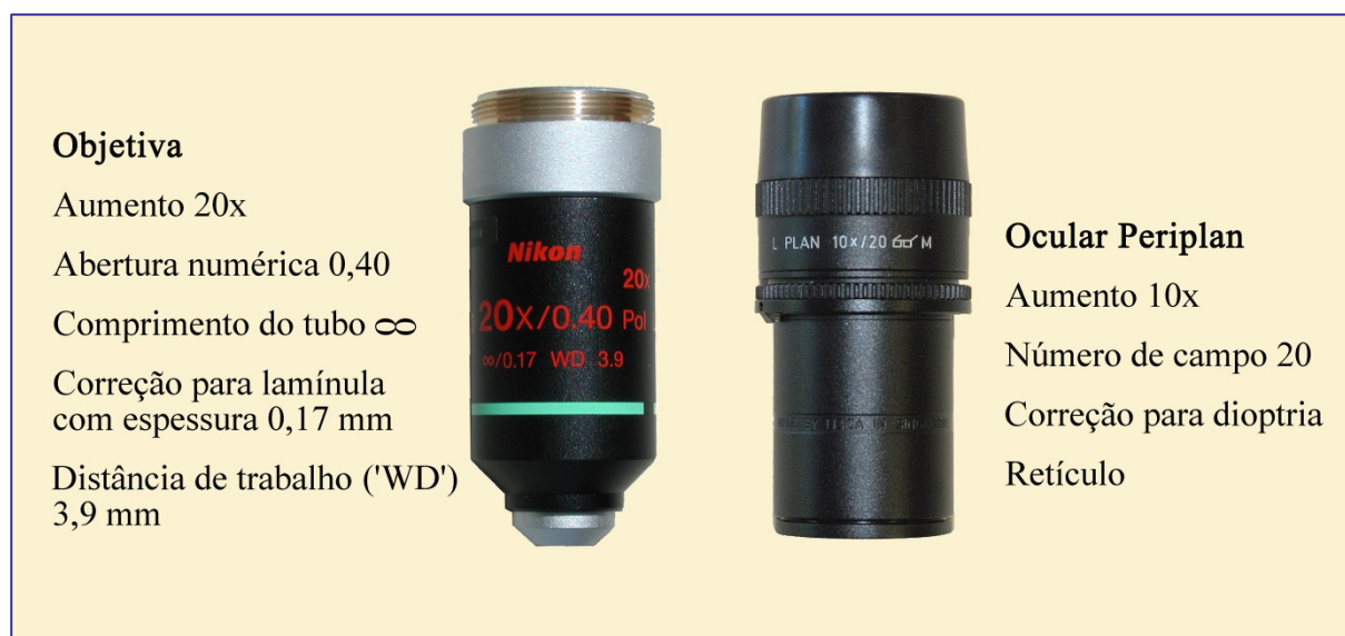
Figura 1-5. Objetiva (Exemplo: Nikon CFI Achromat 20x P) e ocular (Exemplo: Leica Periplan com retículo).
