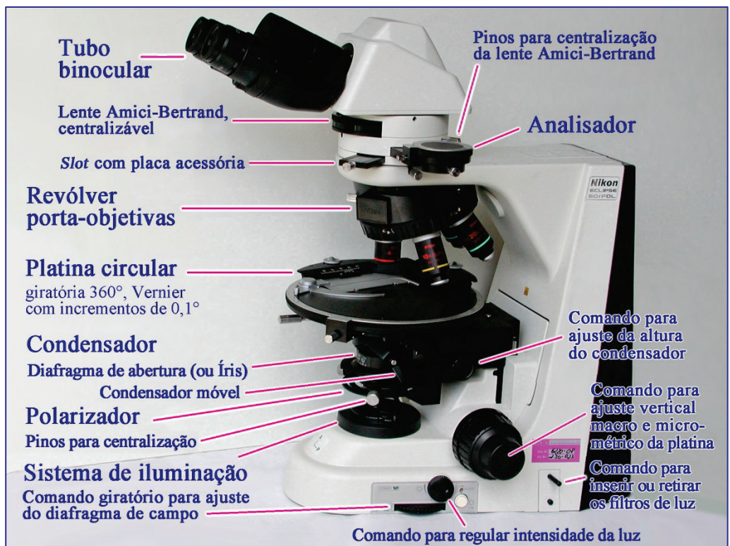
Figura 1-6. Componentes do microscópio de luz transmitida polarizada (Nikon Eclipse 50/Pol; Leica Laborlux 12 Pol).
