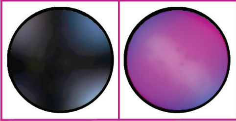
Apatita corte \perp ao eixo óptico 2V_x = 0^\circ \Delta n = 0,003
